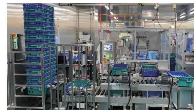
自動供籃機 Automatic basket feeding machine
