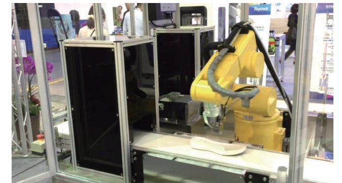
智慧機器人鞋底(面)噴膠機 Robot Outsole Glue Spraying System
