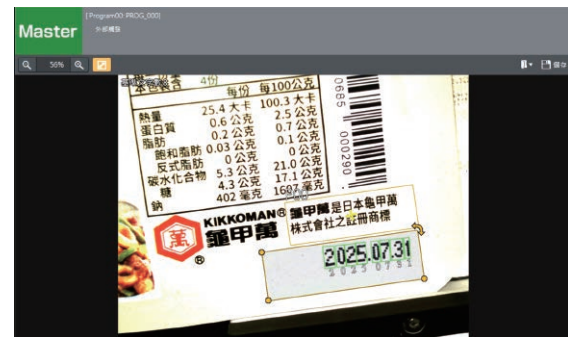
包裝袋 OCR 檢測 OCR identification of bag
