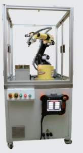
果凍雕花機器人 Robotic jelly carving machine
