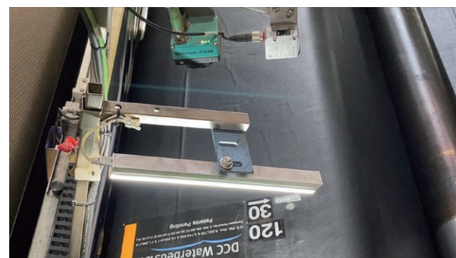
橡膠編號 OCR 辨識 OCR identification of rubber numbers
